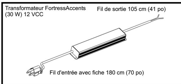
Le transformateur doit être installé à plus de 305 mm (12 po) au dessus du sol.
